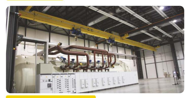
MULTIPOINT SINGLE GIRDER UNDERSLUNG CRANE. CAPACITY UP TO 20+20t.
